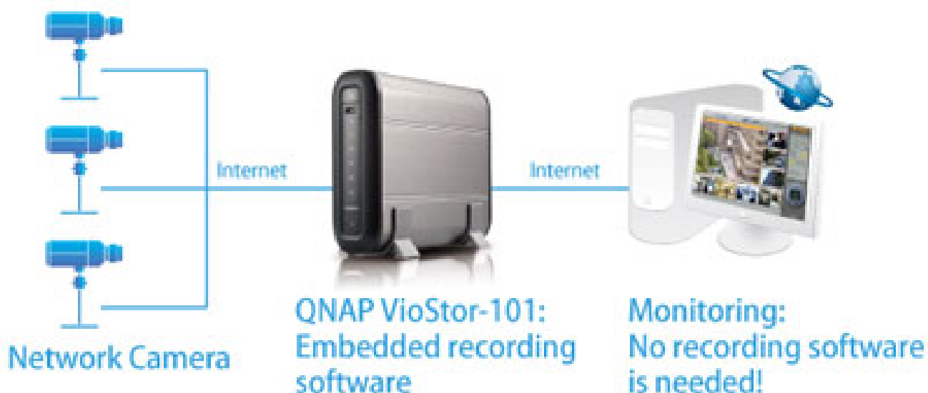
Rys.45 Schemat odbioru on-line obrazu z kamer monitorujących na komputerze, przez sieć internet.
